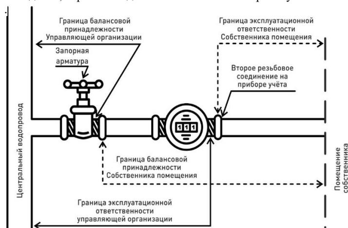
Схема №2. Граница балансовой принадлежности и эксплуатационной ответственности УО при лучевой разводке системы отопления в коллекторном узле
